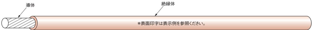
表示例 E304262(UL) MTW FLEXING 14AWG 2.37mm<sup>2</sup> 600V VW-1 OR THHW OR AWM 1015 105C
